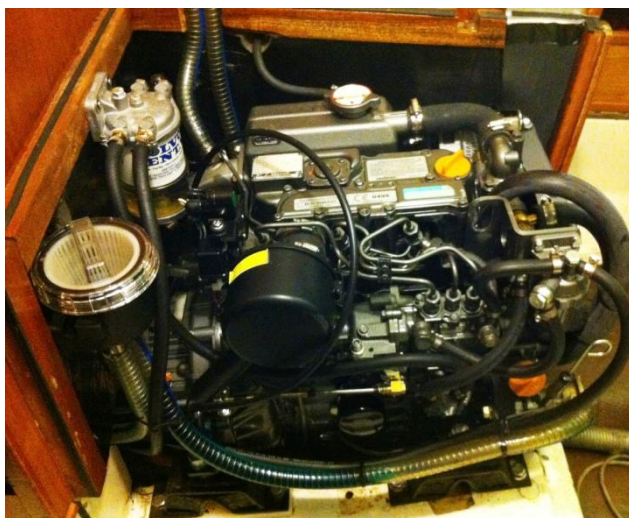
Her kan man se søvandsfilteret (der er over vandlinien) og vandudskilleren
