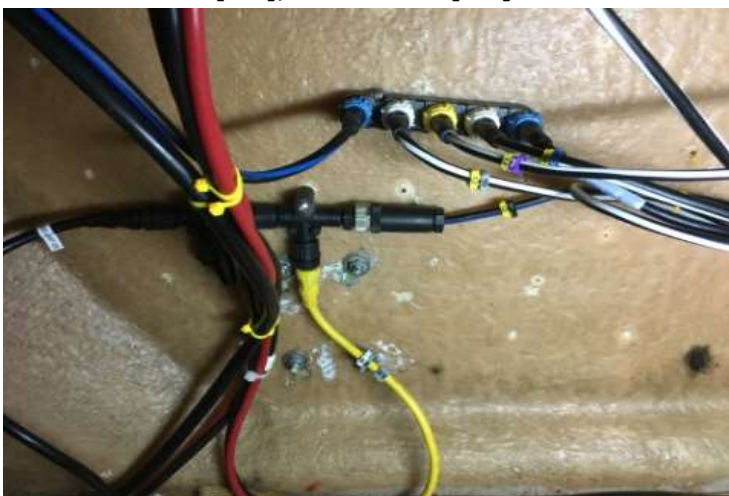
SB sarg. Backbone (og sammenkobling med SeaTalk NMEA2000)
